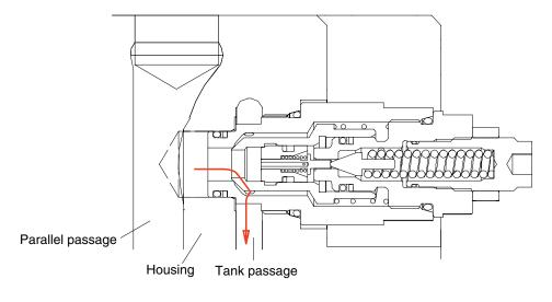
OPERATION 2 OF PORT RELIEF VALVE 220S2MC45
